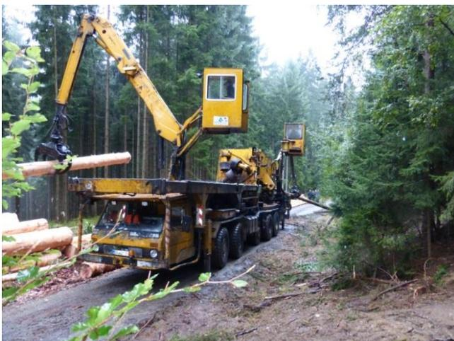
Da die kleinen Sägewerke keine Entrindungsanlage besitzen muss das Holz entweder im Wald oder im Sägewerk mit einer **mobilen Entrindungsmaschine** entrindet werden. Dies wurde den anwesenden Waldbesitzer vorgeführt. Voraussetzung für die Entrindung im Wald ist ein ausreichend großer Lagerplatz. Positiver Nebeneffekt ist, dass: die Nährstoffe der Rinde im Wald verbleiben.
